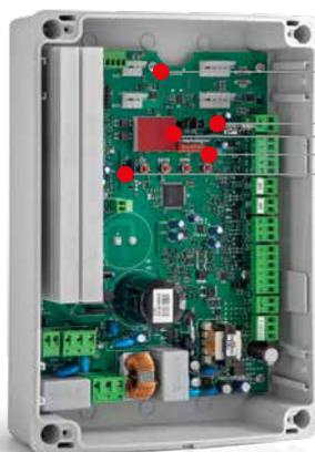
2 alojamientos para **tarjeta enchufable** de mando y de seguridad por radio (burletes de seguridad autocontrolados, detector de espira magnética, decodificador para selector RFID)
